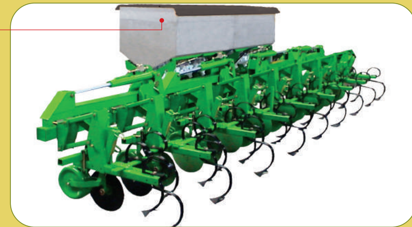
Spandiconcime in acciaio inox 1000 lt Single hopper fertiliser 1000 lt of stainless steel Düngerstreuer Einzelbehälter 1000L aus Edelstahl Inox Fertiliseur trémie unique de 1000 lt en acier inox
