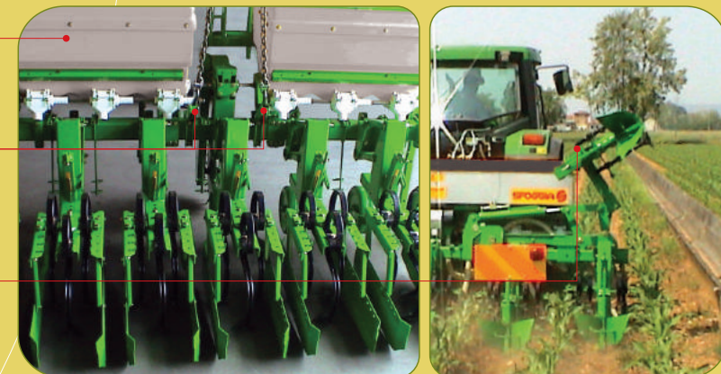
Ripiegamento idraulico mezza fila esterna Hydraulic folding of the external half unit Hydraulisches Klappen vom außenliegenden Halbaggreat Replage hydraulique du demi élément extérieur
