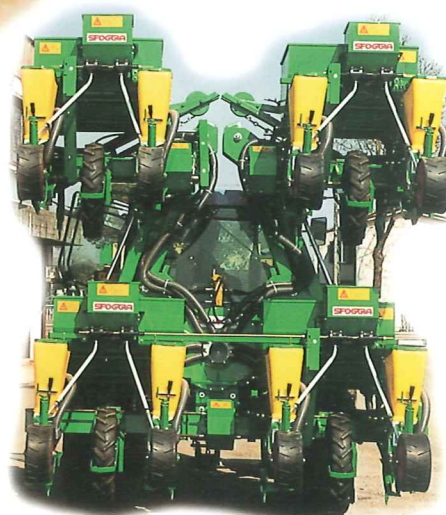
8 file mais, 75 cm, idraulica ripieghevole, con spandiconcime e microgranulatore. 8-row maize, 75 cm, hydraulic folding, with fertiliser and microgranulator. 8-reihig Mais, 75 cm, hydraulisch klappbar, mit Dünger- und Mikrogranulatstreuer. 8 rangs maïs, 75 cm, repliable hydraulique, avec distributeur d'engrais et microgranulateur. 8 hileras maíz, 75 cm, plegable hidraulica, con fertilizante y insecticida.
