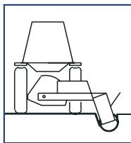
Stroj pracuje na bočnej strane 200 až 260 cm od traktora. Stroj je prepravovaný v zvislej polohe. Pomocou hydraulického valca sa stroj dostane do pracovnej polohy. Ďalší hydraulický valec umožňuje bočný posuv rotora.
