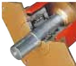
Il rotore è sostenuto da due robusti supporti in acciaio, provvisti di cuscinetti orientabili a rulli di notevoli dimensioni. La totale assenza di vibrazioni e la perfetta assialità sono garantiti dal bloccaggio mediante bussole di trazioni coniche.
