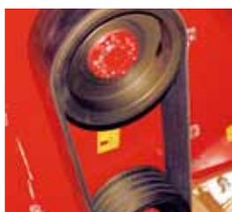
Trasmissione del moto all'albero rotore realizzata per mezzo di monocinghia dentata avvolta su pulegge a 5 gole che assicurano la massima aderenza ed una perfetta ventilazione; l'assenza di vibrazioni ed un sicuro bloccaggio sono garantiti dall'utilizzo di calettatori conici.
