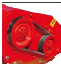
Trasmissione del moto dell'albero rotore realizzata per mezzo di cinghie dentate avvolte su pulegge equilibrate che assicurano la massima aderenza ed una perfetta ventilazione; l'assenza di vibrazioni ed un sicuro bloccaggio sono garantiti dall'utilizzo di calettatori conici.
