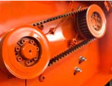
Trasmissione dell'albero rotore con monicinghia e puleggia dentata Single toothed belt drive transmission with toothed pulley Ременной привод с зубчатый шкив карданного вала
