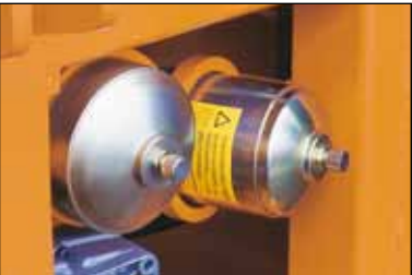
Kit oleopneumatico per sospensione 1° braccio Air hydraulic kit for 1st arm suspension Гидродинамическое движение стрелы
