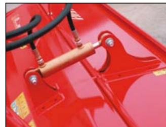
Martinetto idraulico per apertura del cofano posteriore.
