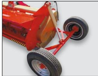
Kit opzionale trasporto in lungo idraulico con 2 ruote montato all'origine.
