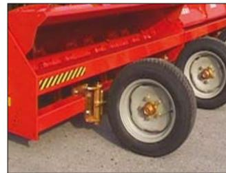
Ruote semi-pivottanti regolabili in altezza e larghezza.
