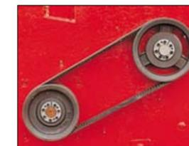
Trasmissione del moto dell'albero rotore realizzata per mezzo di cinghie dentate avvolte su pulegge equilibrate che assicurano la massima aderenza ed una perfetta ventilazione ; l'assenza di vibrazioni ed un sicuro bloccaggio sono garantiti dall'utilizzo di calettatori conici.
