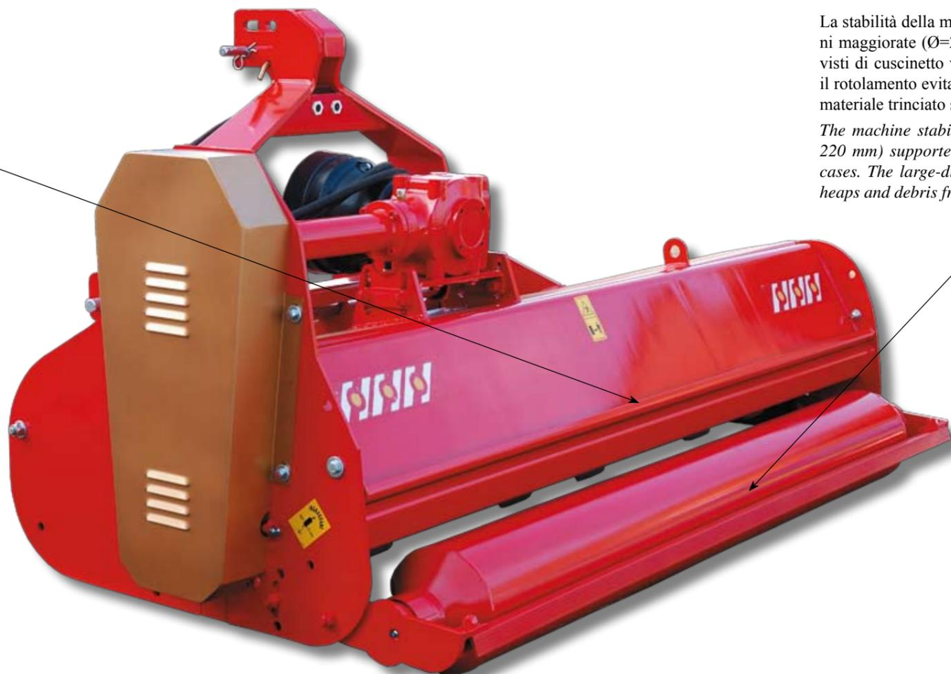
La stabilità della macchina è ottimizzata da un rullo di dimensioni maggiorate ( $\varnothing=220$  mm) sostenuto da supporti a cuffia provvisti di cuscinetto volante; il diametro elevato del rullo facilita il rotolamento evitando la formazione di mucchi ed il deposito di materiale trinciato sulla sua superficie.
