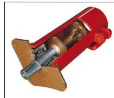
Il rotore è sostenuto da due robusti supporti in acciaio, provvisti di cuscinetti orientabili a rulli di notevoli dimensioni. La totale assenza di vibrazioni e la perfetta assialità sono garantiti dal bloccaggio mediante bussole di trazione coniche.
