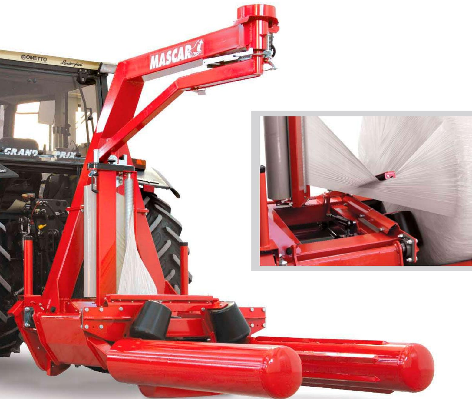
Sincronismo tra la rotazione della balle ed il satellite; La sovrapposizione del film costante a tutte le velocità. Impostazione dell'altezza del film (da 750 o 500) con inversione del pignone della trasmissione. Modello "1600B" dotato di freno idraulico per evitare la libera rotazione del satellite in collina.
